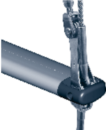
Salingendbeschlag für gelinkte Mittelwanten.
