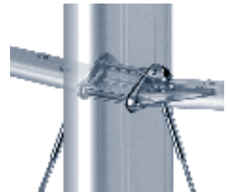
Durchgehender Salingbeschlag hat eine integrierte Aufnahme für die Unter- oder Mittelwanten.
